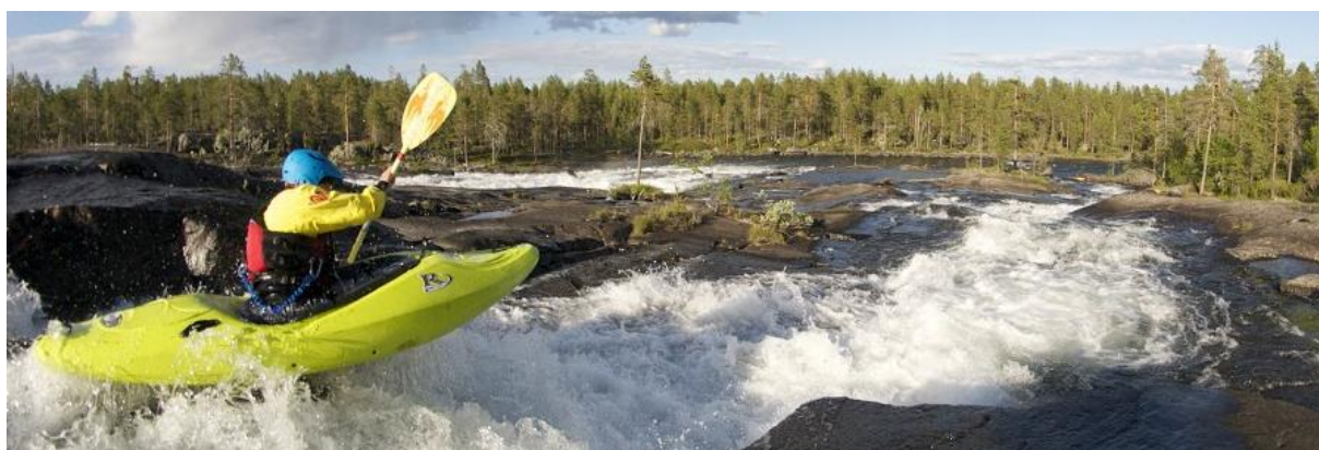
Bild 5. En creekingpaddlare i övre delen av Sicksackrännan i Trollforsarna, Pite älv. Klass IV creeking med en lutning på ca 8 %. Kajaken är av tålig hårdplast, är relativt bred med fylliga och uppsvängda stävar för att flyta bra, inte fastna på stenar (jmf brättet på en skida för pudersnö) och vara lättsvängd. Foto: Jon Lundström
