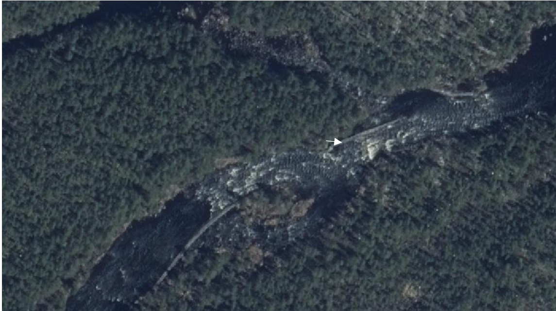
Bild 14. Flygbild över Övre Ålkarsströmmen i Voxnan som visar ett omfattande system av ledarmar som stänger av sidofåror och kanaliserar det mesta av vattenflödet till en enda bred huvudfåra. Forsen kommer troligen att göras om inom Rivers of LIFE-prjektet (17). Ledarmen vänster i Bild 14 är tagen vid den vita pilen.
